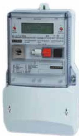
**L'MT860** è un contatore elettronico multifunzione ad alta precisione (in classe 0,25) a connessione indiretta, per la misura e la registrazione di energia attiva, reattiva e apparente, nonché delle curve di potenza. L'apparecchio è adatto per utenze commerciali e industriali aventi dimensioni medio-grandi. Il contatore soddisfa gli standard IEC62053-21, IEC62053-22, IEC62053-23, ISO9001.
